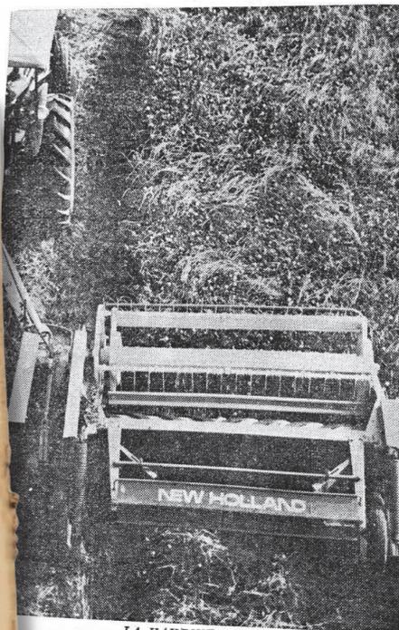
LA HAYBINE 444 : Faucheuse - conditionneuse - andaineuse
