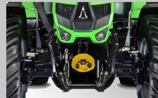
Relevage puissant d'une capacité de levage pouvant atteindre 2 880 kg. Pack confort avec un distributeur supplémentaire disponible à l'avant.
