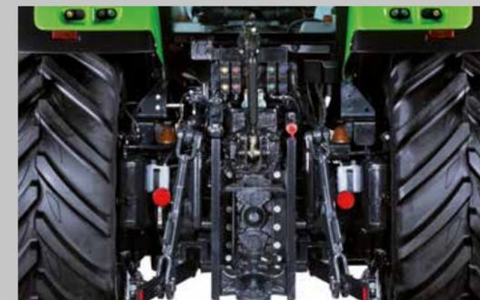
Des caractéristiques impressionnantes. Capacité de relevage pouvant atteindre 7 000 kg, 3 vitesses de PDF et catégorie III.
