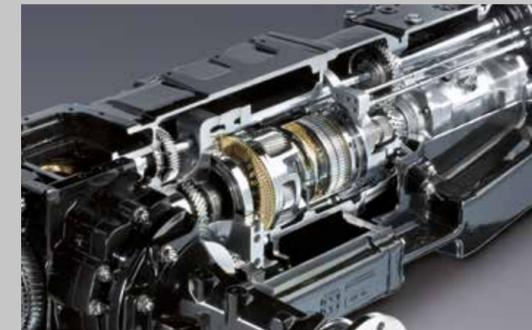
Productivité maximale, transmission précise et vitesses d'exécution exactes : les modèles de la nouvelle série 6 sont équipés de la très efficace transmission TTV à variation continue.
