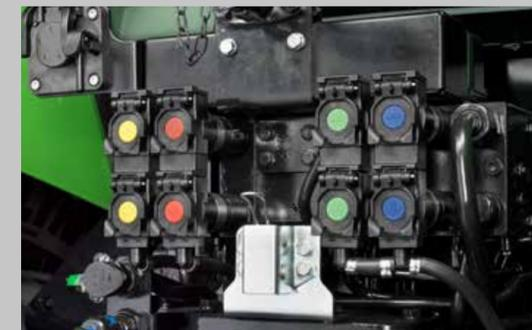
Excellente manipulation des outils. Circuit hydraulique Open Center de 90 l/min avec jusqu'à 4 distributeurs supplémentaires mécaniques, ou système hydraulique Load Sensing de 120 l/min avec jusqu'à 4 distributeurs supplémentaires mécaniques ou 5 à commande électronique.
