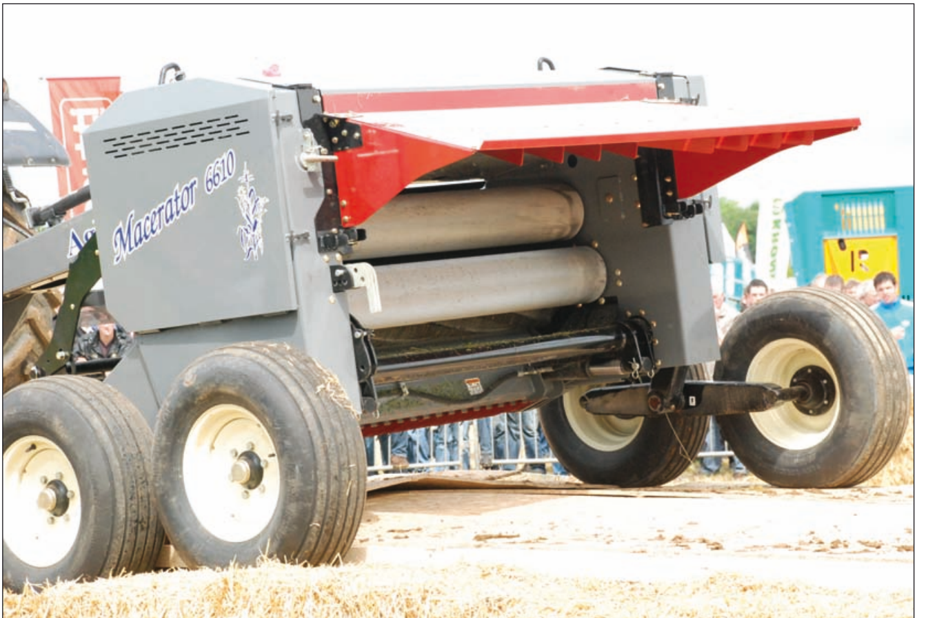
La pression plus ou moins forte sur les rouleaux cannelés intensifie ou réduit le conditionnement.
