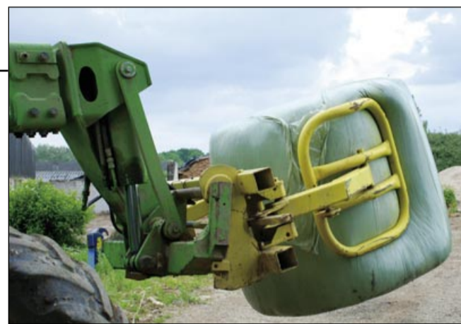
Le pince-balles ramasse sans dommage les balles d'enrubannage.
